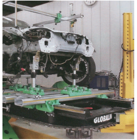
ヨーロッパの自動車メーカーが認めた最新マシンのジグ修正機を導入
